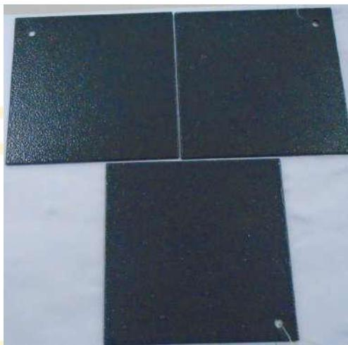
Amostras após ensaio de Salt Spray
